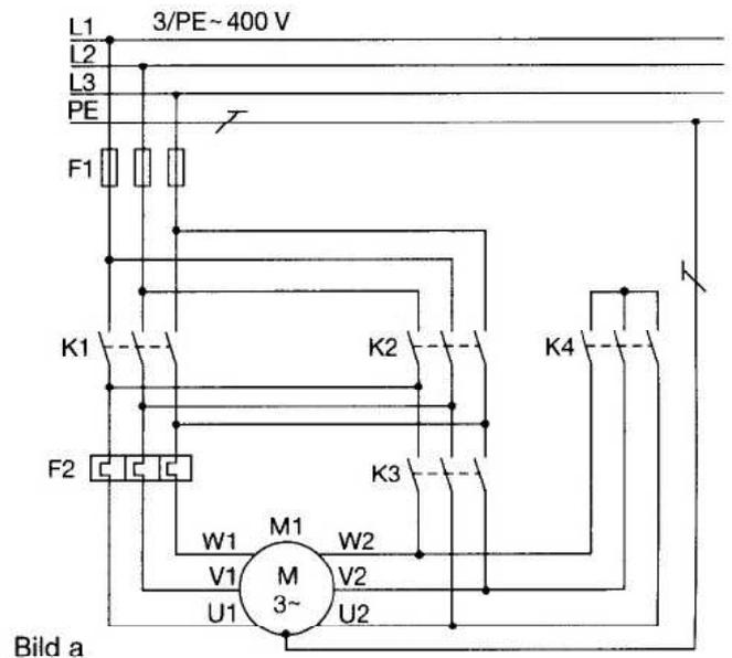
8. Bild a. Durch Betätigung des Tasters -S1 wird der Motor -M1 eingeschaltet (Rechtslauf). Wird -S2 betätigt, so wird der Motor durch Gegenstrom abgebremst. Der Bremswächter -F3 schaltet beim Unterschreiten von  $40 \text{ min}^{-1}$  den Bremsvorgang ab. An welcher der genannten Stellen des Stromlaufplans muss der Schließkontakt des Bremswächters eingefügt werden?
